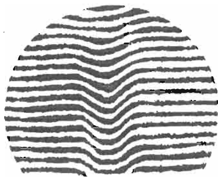
Рис. 2. Типичная интерферограмма компрессионного потока КСПУ.
