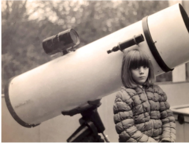
Аљошина ќер Маја поред Њутновог рефлектора, огледало= 33цм. Направио Аљоша средином 1980-их.
