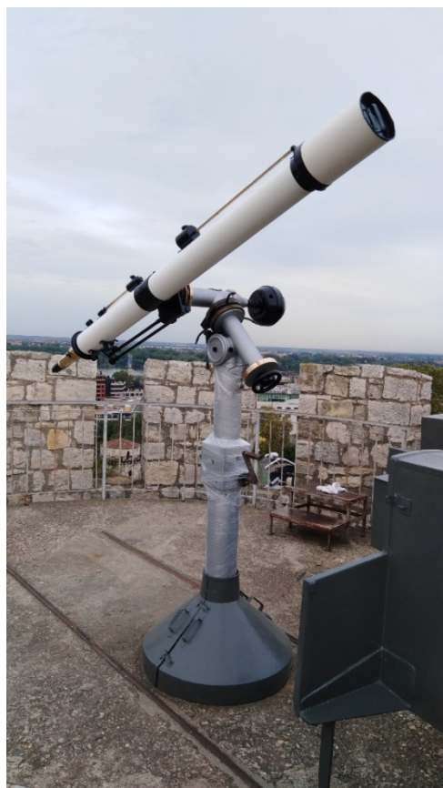
Слика 15: Телескоп Цајс 110/2030 mm после рестаурације.
