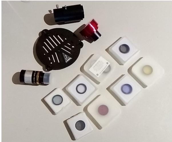
Слика 13: Нова астрономска опрема. У горњем делу су: астрокамера са адаптером, Бахтинов маска и окулар са променљивом жижном даљином.
