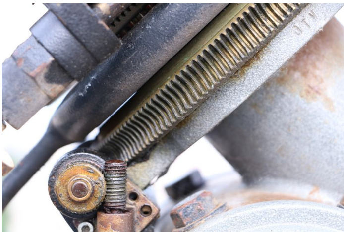
Слика 5: Затечено стање ректасцензијског зупчаника, кочнице и преносника ка мотору.
