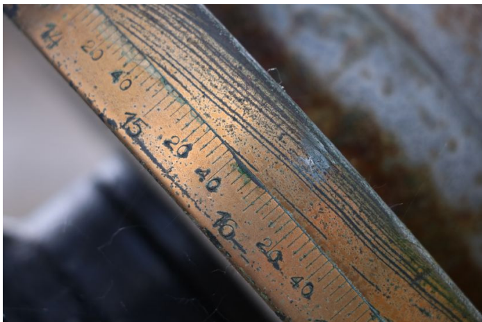
Слика 6: Изглед ректасцензијског подеоног круга пре реконструкције.
