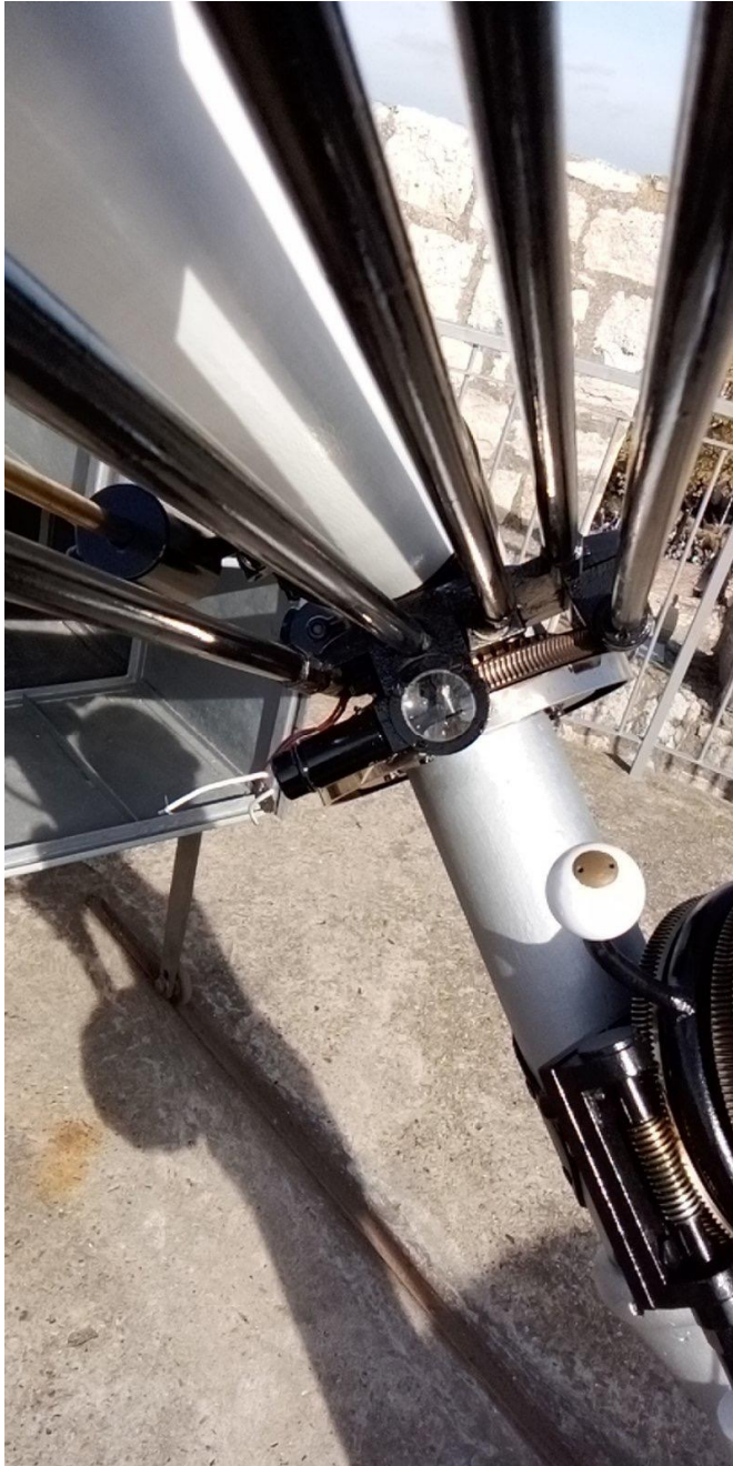
Слика 21: Приказ додате лупе за читавање деклинацијског круга. Могу се уочити завртњи за фино померање, ректасцензијски зупчаници и груба кочница. Са леве стране се види шина која носи контратег након враћања оригиналног сјаја.
