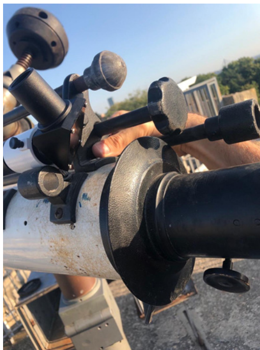
Слика 7: Стање носача фокусера и завртања за фино померање.
