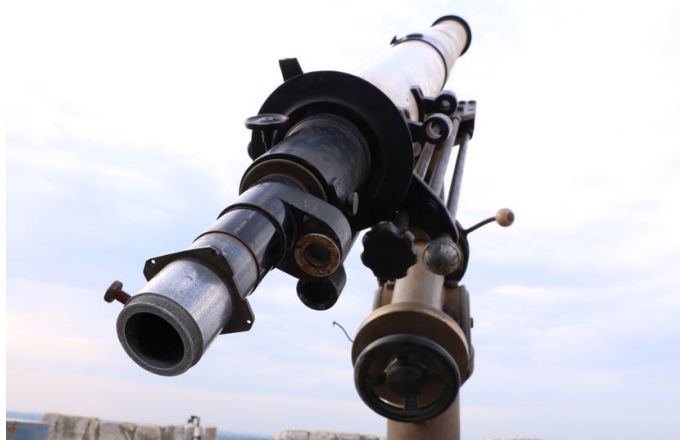
Слика 9: У првом плану се налази неодговарајући носач окулара.
