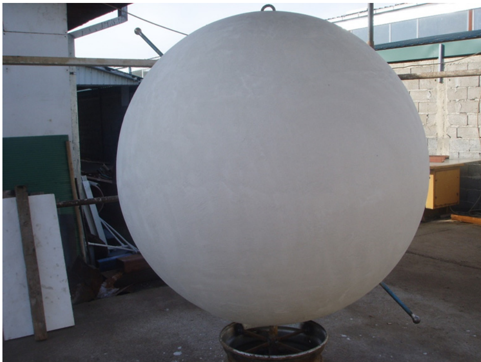
Слика 11: Жичана конструкција је потпуно прекривена фeroцементом и кугла је искошена да би глобус постао Паралелни глобус.
