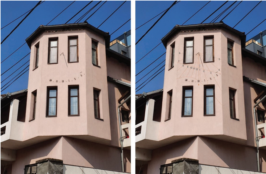
Слика 6. а) Кућа у Скадарској 7 са сунчаним сатом, б) Гномонска скала сата конструисана по правилима гномонике
